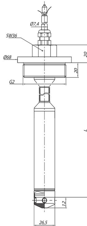
(с защитной стальной трубкой и гайкой G2)
